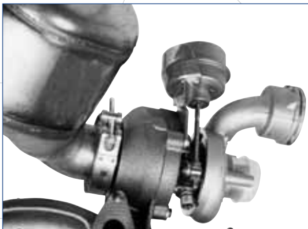
Соединение «турбоагнетатель – катализатор»
