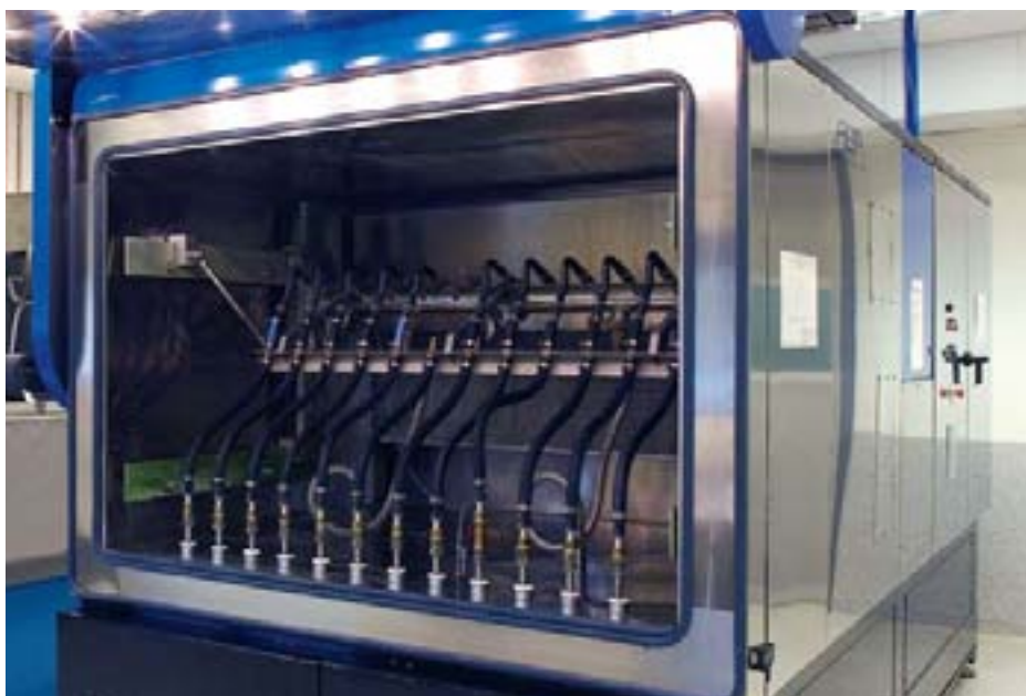
Оборудование для проведения вибрационных, температурных тестов и тестов на изменение давления.
